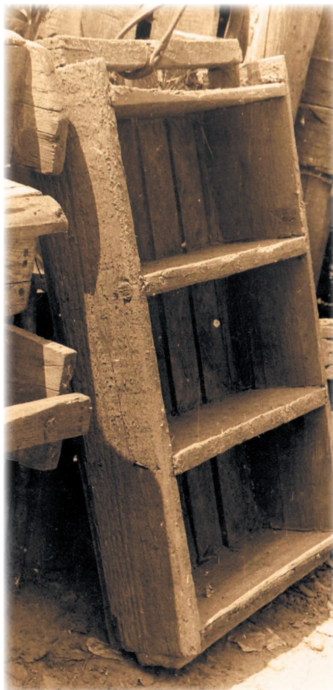
Форма для саманных кирпичей (архив М.В. Маруневич) Saman kerpiçlerä kalup (M.V. Maruneviç arhivi)
